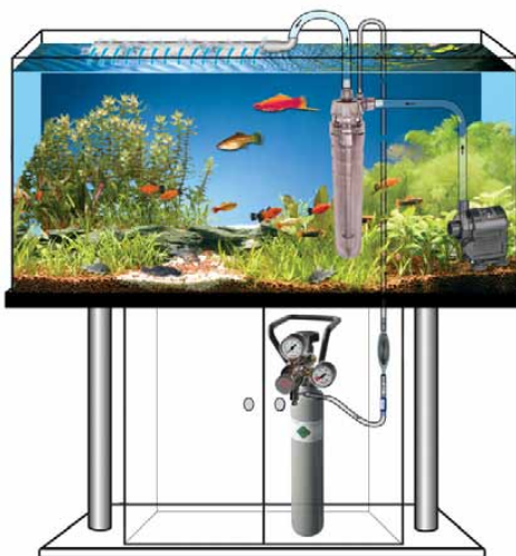
Montage in het aquarium met een aparte pomp
